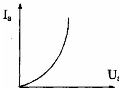
Рис 2.4 - Диодная характеристика при наличии объемного заряда
